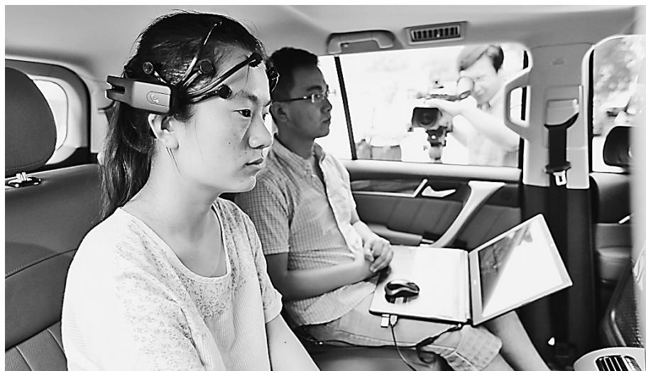
7月15日,在天津南开大学,一位研发团队成员(左)头戴脑电信号采集设备控制汽车行驶。
