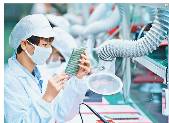
位于七台河市经济开发区一高新企业生产的超薄可任意变形的小间距、防水“球形”LED景观屏等高科技产品,销往国内各地及远销俄罗斯、英国等多个国家。图为技术人员在检查嵌入式印刷电路板灯板。 王慧斌 本报记者 邱成摄
