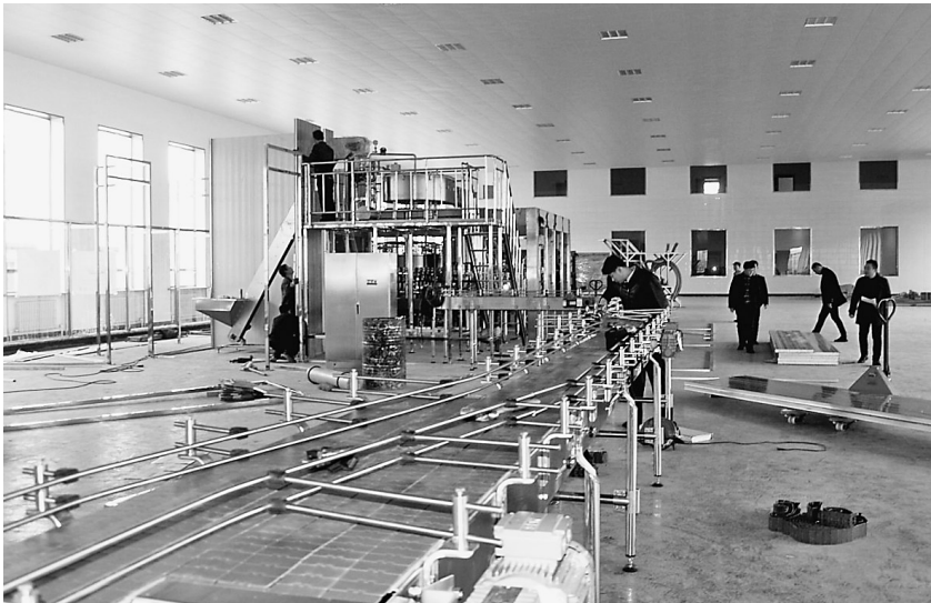
航天长源矿泉水厂施工人员正在抓紧安装矿泉水生产线。
