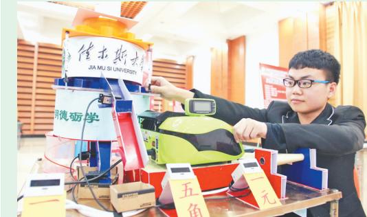
日前,佳木斯大学大学生发明了新型“零钞”分拣机。该机械由混钞分拣、硬币分拣、纸币分拣三个功能模块组成,能够实现对混币的自动分拣、整理和计数等功能。
