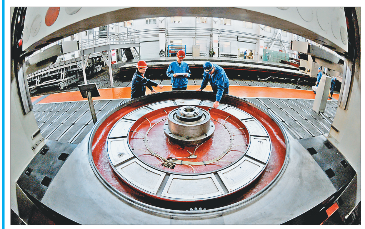
今年以来,齐齐哈尔以“创新驱动”为着力点,针对“高档数控机床产业化”不断扩大高端产品技术优势。在新产品开发上,进一步对多工位压力机进行国产化设计,并开发压力机伺服技术。目前,已成为国内机床行业品种最多、服务领域最广的装备制造企业,先后为国防、军工、能源、汽车等领域提供近千台套重大关键装备。 图为技术人员正在装配8米双柱数控立式车床。 刘超 本报记者 邵国良摄
