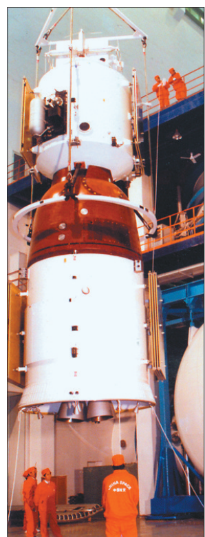
神舟号飞船正准备进入地面空间环境模拟器做实验。王若维摄
