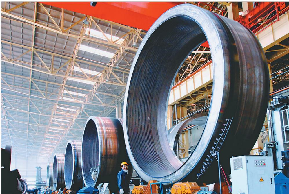
一重机电石化事业部双带极自动堆焊生产线。
