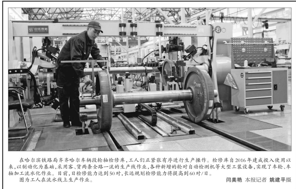
在哈尔滨铁路局齐齐哈尔车辆段轮轴检修库,工人们正紧张有序进行生产操作。检修库自2016年建成投入使用以来,以制动化为基础,采用客、货两条全路一流的生产线作业,各种新增的轮对自动检测机等大型工装设备,实现了车轮、车轴加工流水化作业。目前,日检修能力达到50对,长远规划检修能力将提高到60对/日。
