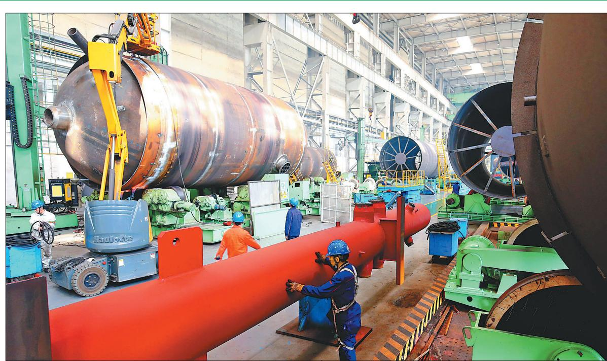
哈尔滨锅炉厂有限责任公司负责生产制造的福清5、6号机组除氧器和高压加热器是核电“华龙一号”关键部件,除氧器全长50米,直径近5米。作为中国核电“走出去”的主打品牌,华龙一号在设计创新方面提出了“能动和非能动相结合”的安全设计理念,安全指标和技术性能达到了国际三代核电技术的先进水平,具有完整自主知识产权,国际竞争优势明显。图为哈锅重容分厂正在装焊除氧器。
