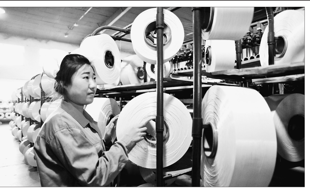
坐落于绥棱经济开发区的黑龙江省龙海纺织有限公司主要以废旧矿泉水瓶(聚酯包装瓶)为原料,经过融化、拉丝、加弹等工序生产涤纶长丝,既实现了废旧物资的循环利用,又解决环保问题。目前,企业拥有年加工2万吨涤纶长丝生产线一条、46部位涤纶POY生产线、10条加弹生产线,年可实现产值2亿元,解决就业300余人。
