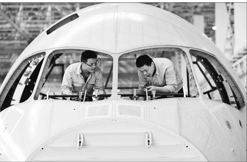
图为4月28日,工人在进行C919驾驶舱风挡装配操作。 新华社记者 刘坤摄
