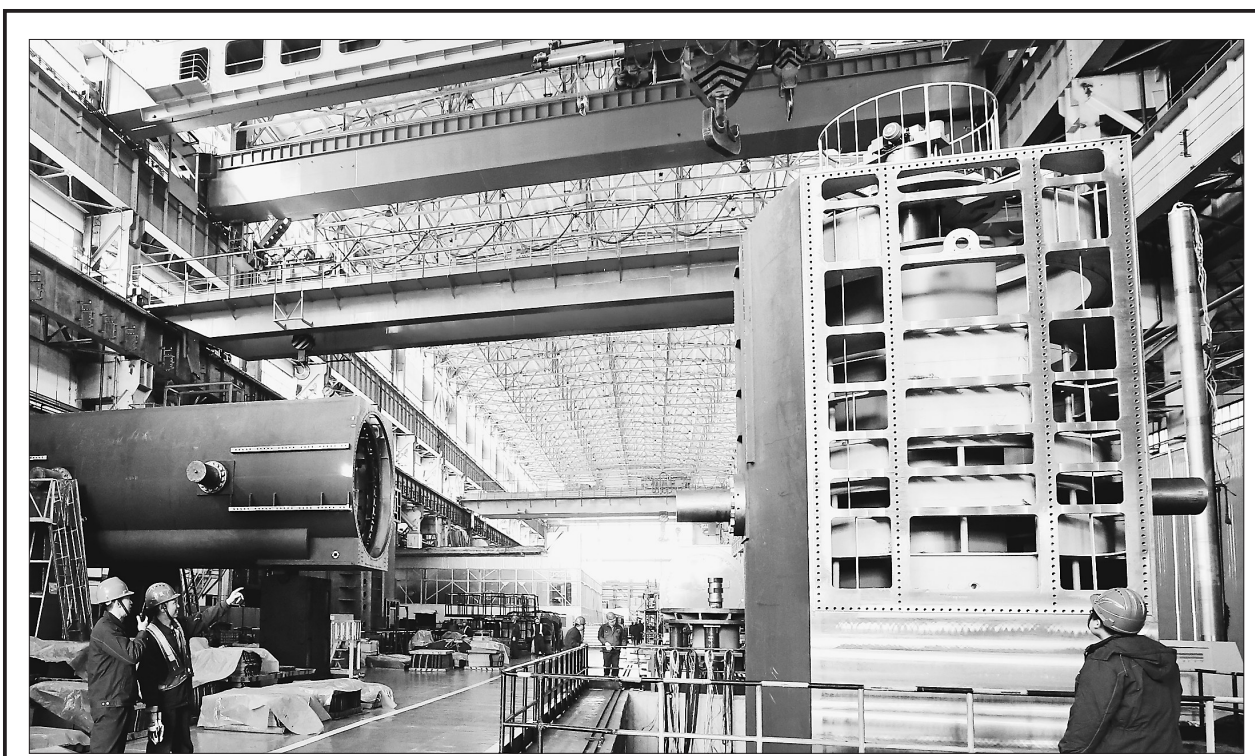
哈电集团哈尔滨电机厂有限责任公司制造的江西九江丰城项目1000兆瓦级超超临界机组,是当前国际火力发电领先技术二次再热技术的配套产品,具有高效率、低能耗、低排放等优势。哈电机公司将为该项目制造2台当前国内单机容量最大的1000兆瓦级汽轮发电机。图为丰城2号机机座正在进行内环的车序加工。 富宏杰 王学善 本报记者 邱成摄
