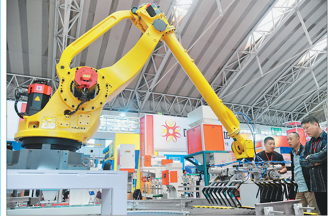
哈尔滨联科自动化技术公司研制的自动化搬运机器人，被广泛应用于机床上下料、冲压机自动化生产线、自动装配流水线、码垛搬运、集装箱等的自动搬运。图为该产品在哈尔滨国际装备制造业博览会上刚一亮相便吸引了众多客商的目光。 本报记者 郭俊峰摄
