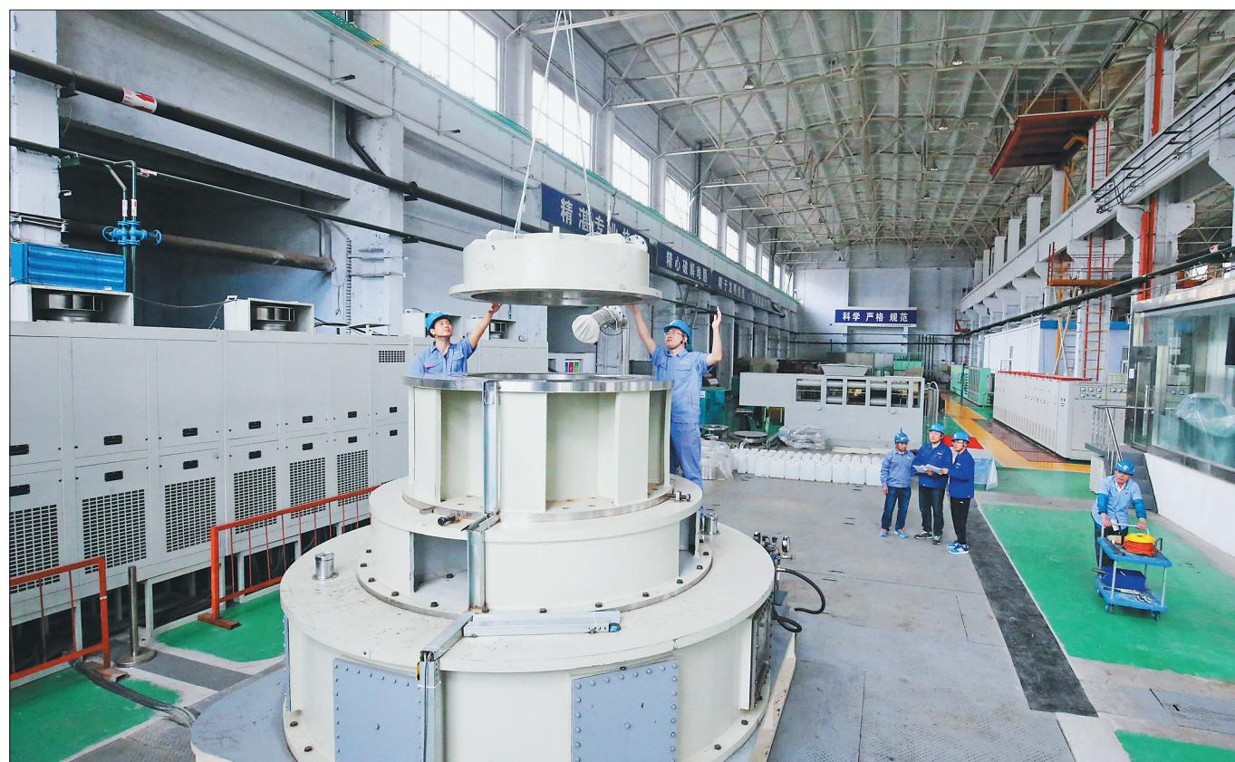
日前，哈电集团哈尔滨电机厂有限责任公司自主研发的第三代核主泵电机水润滑推力轴承顺利完成72小时试验，成功突破了我国第三代核主泵电机水润滑推力轴承的设计难题，大大推进了核主泵电机国产化进程。通过验证的核主泵电机水润滑推力轴承，将能够满足核主泵电机60年免维护、抗磨、耐腐蚀、无污染、耐辐照的要求，标志着我国水润滑推力轴承研发技术达到了世界领先水平。
