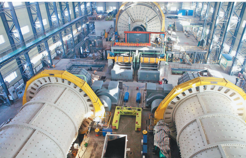
亚洲最大半自磨机及国内最大、最先进的2台钼矿球磨机。
