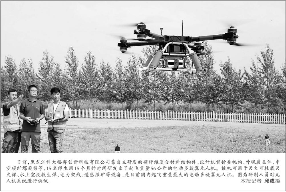
日前,黑龙江科大格界创新科技有限公司靠自主研发的碳纤维复合材料结构件、设计机臂折叠机构、外观覆盖件、中空碳纤维蒙皮等,15名师生用15个月的时间研发出了起飞重量56公斤的电动多旋翼无人机。该机可用于灭火可挂载灭火弹、水上空投救生弹、电力架线、遥感探矿等设备,是目前国内起飞重量最大的电动多旋翼无人机。图为研制人员对无人机系统进行调试。 本报记者 邱成摄
