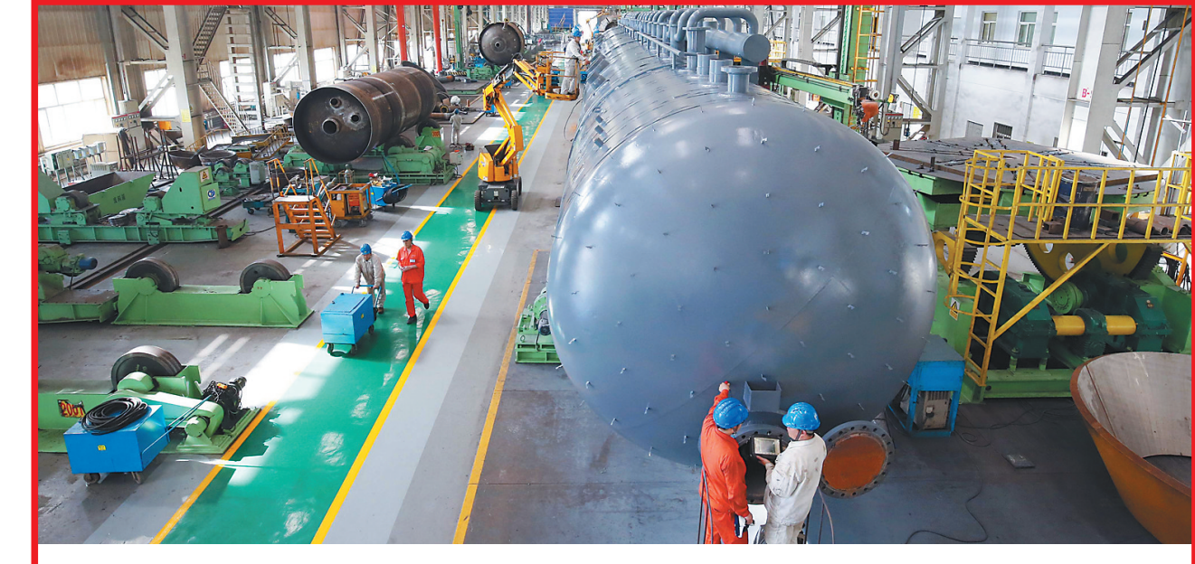
6日,哈尔滨锅炉厂为安徽芜湖生产制造的长达42米,满水吨位达685吨的单筒式内置除氧器保质按期完成,他们以优质产品献礼十九大。截止目前,哈锅产品已累计出口到近30个国家和地区。许雪峰 本报记者 邱成摄
