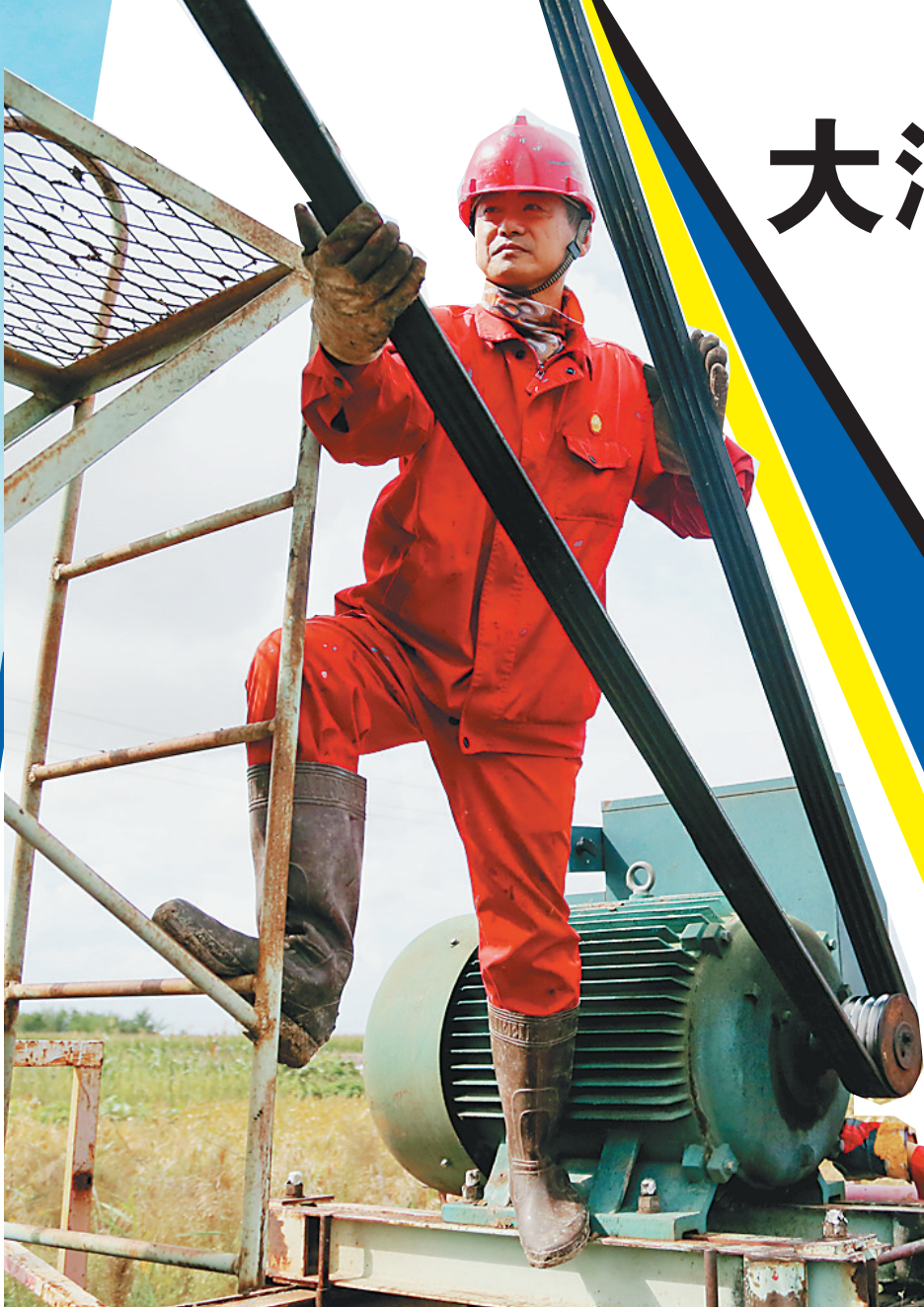
在“喜迎十九大,争做效益先锋”活动中,采油三厂一矿员工从小事做起、从点滴细微处入手,牢固树立节约挖潜增效意识。图为这个矿采油206队员工在认真调整皮带四点一线和松紧度。
