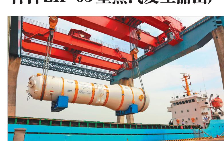
10月17日,中国自主三代核电“华龙一号”国内首台ZH-65型蒸汽发生器在位于广州南沙的东方电气(广州)重型机器有限公司吊装出厂并运往福建。这标志着中国第三代核电设备自主设计制造能力已经成熟,中国核电装备制造技术和水平跻身世界前列。
