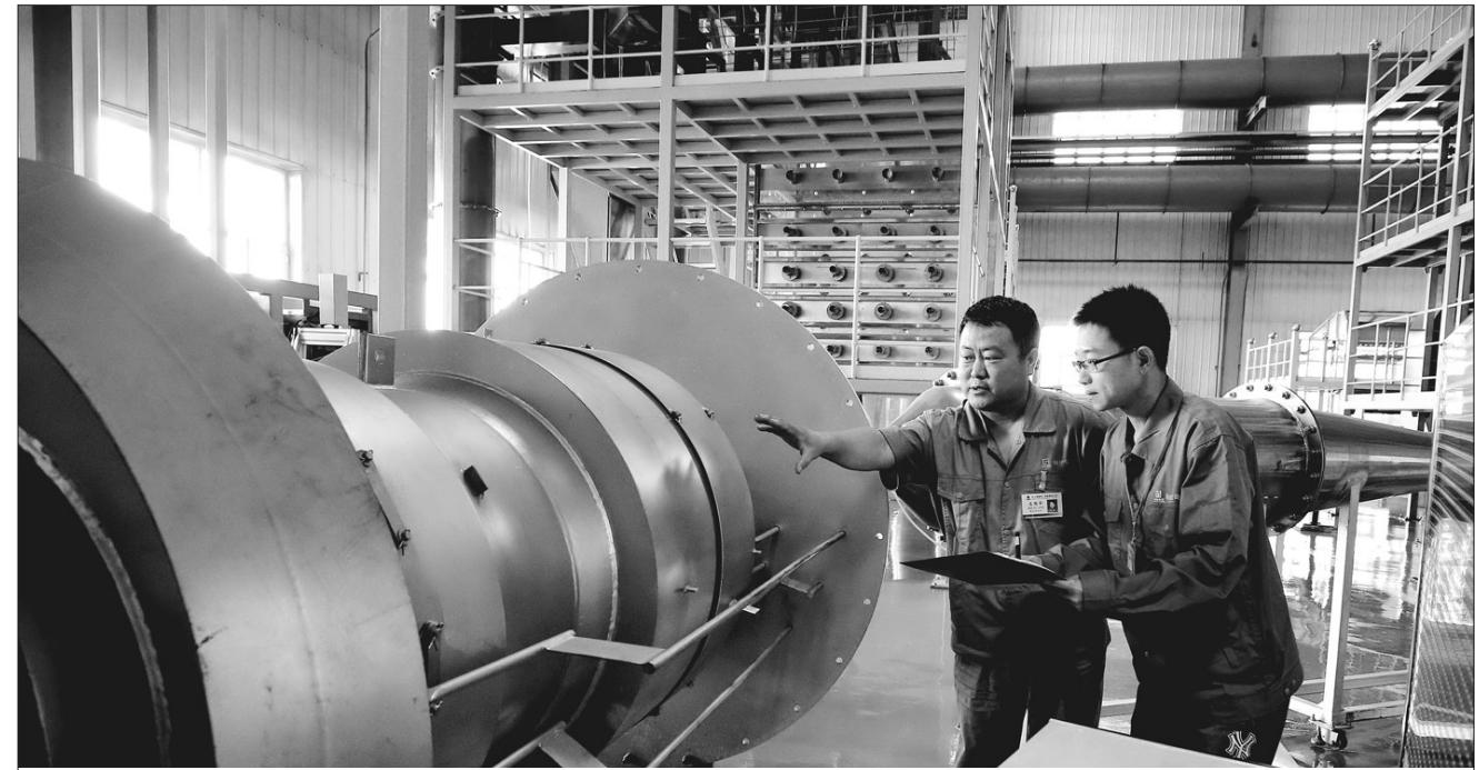
哈锅积极落实国家创新驱动发展战略,瞄准劣质煤炭燃烧利用的世界性难题进行深入研究,加大自主研发力度。投资2亿元建设的目前世界上热容量最大、系统最完善、控制最先进、最接近工程实际的清洁高效燃烧试验平台,已经开展了新疆准东煤结焦特性研究、国内外动力用煤特性分析等20余项重大科研项目,攻克了准东煤燃烧世界性难题,抢占了技术制高点。图为科技人员正在讲解哈锅自主研发的旋流燃烧器。
