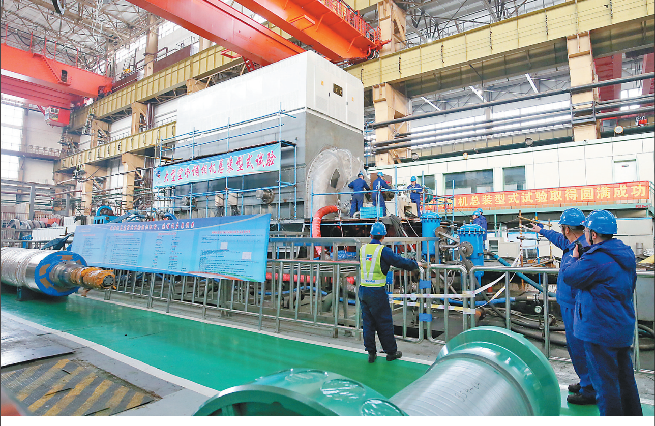
日前,世界首台特高压直流输电全空冷300兆乏调相机在哈电集团哈尔滨电机厂有限责任公司完成全部制造及试验过程。经过产品的总装型式试验和联调并网试验验证,该产品各方面参数、性能、指标均满足国家电网公司及设计方案要求,暂态运行指标和过载能力表现卓越。至此,哈电机成为首家具备300兆乏全空冷调相机制造能力的企业。 图为试验现场。 富宏杰 王学善 本报记者 邱成摄
