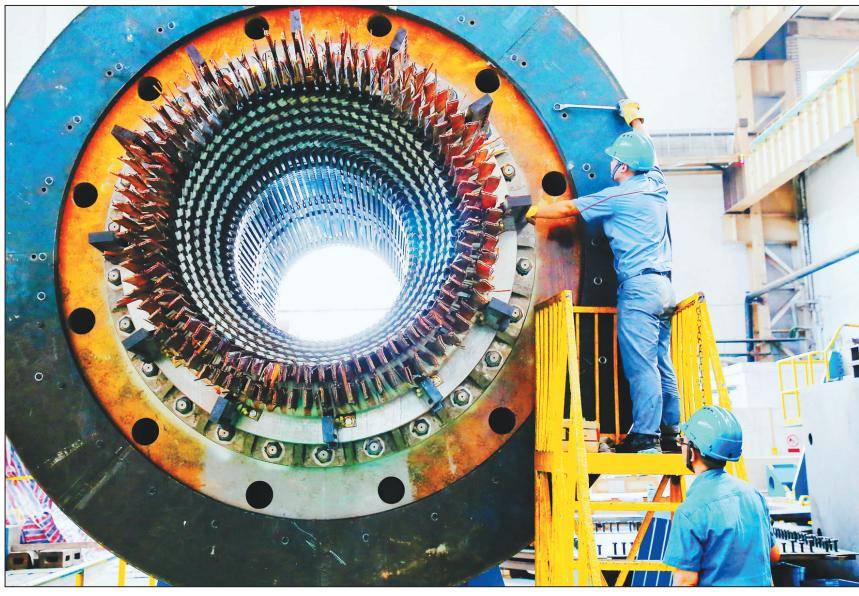
哈电集团哈尔滨电机厂有限责任公司注重创新驱动，加大节能环保新产品开发力度，近日成功突破了青海共和项目50兆瓦空气冷却光热汽轮发电机生产难关，推动该项目定子机组生产进入了嵌线工序。该项目是2016年9月国家公布的首批示范项目之一。
