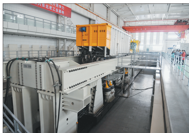
中车齐车集团整车疲劳与振动试验台。本报记者 郭俊峰摄
