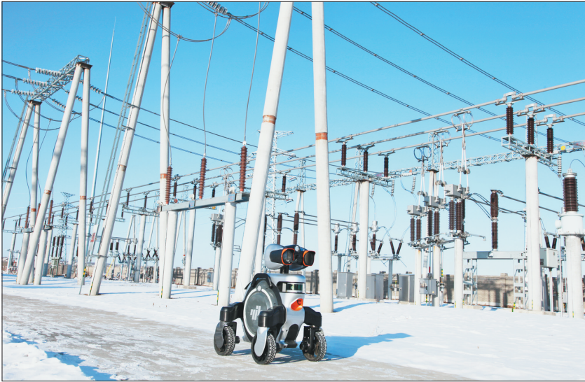
智能机器人在220千伏锦江变电站开展变电设备后台巡查。 省电力公司提供
