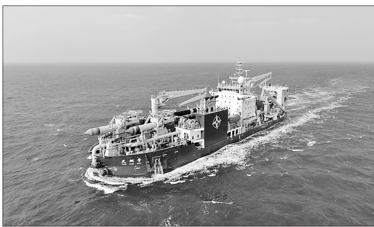
“天号”在海上航行。1月9日12时30分,经过近3个月的挖泥、挖岩试验,由中交天津航道局投资建造的亚洲最大重型自航绞吸船“天号”顺利返航回到船厂,标志着“天号”完成全部测试,正式具备投产能力。新华社发
