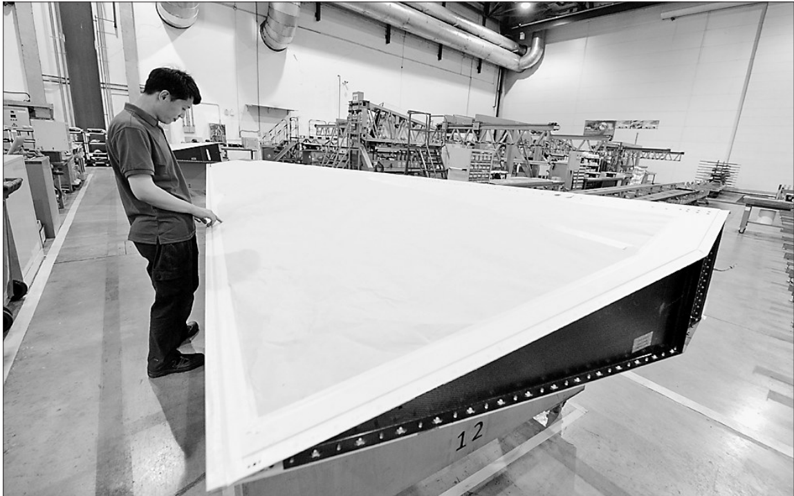
哈飞空客复合材料制造中心成功运营十年,采用最先进的复合材料制造工艺和管理经验,为A350XWB宽体飞机和A320系列飞机制造复合材料部件。目前,该中心是空客A350XWB宽体飞机方向舵、升降舵、机腹整流罩和S19维护舱门等工作包的复合材料结构件唯一供应商。
