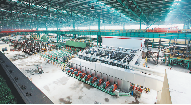
黑龙江建龙180无缝钢管热处理生产线。
