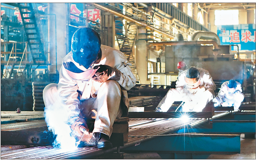
哈电锅炉管子二分厂装焊组工人正在对巴基斯坦贾姆肖罗项目分隔屏进行焊接。 赵文博摄
