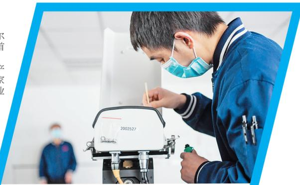
▲双光谱测温仪安装调试生产现场。 新光光电提供
