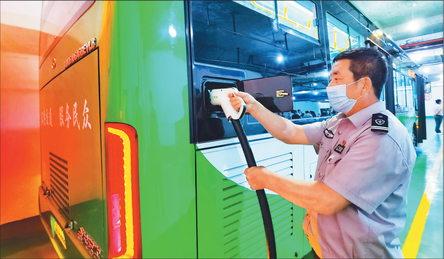
七台河市公共汽车停车场,工作人员正在给新能源公交车充电。
