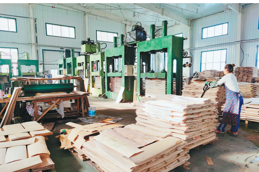
涂好胶的白板在这里经冷压机定型压平。
