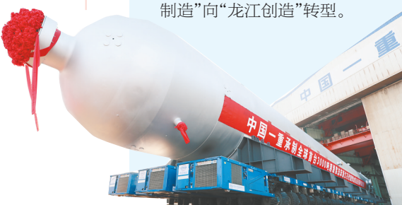
中国一重承制的全球首台3000吨浆态床加氢反应器。
