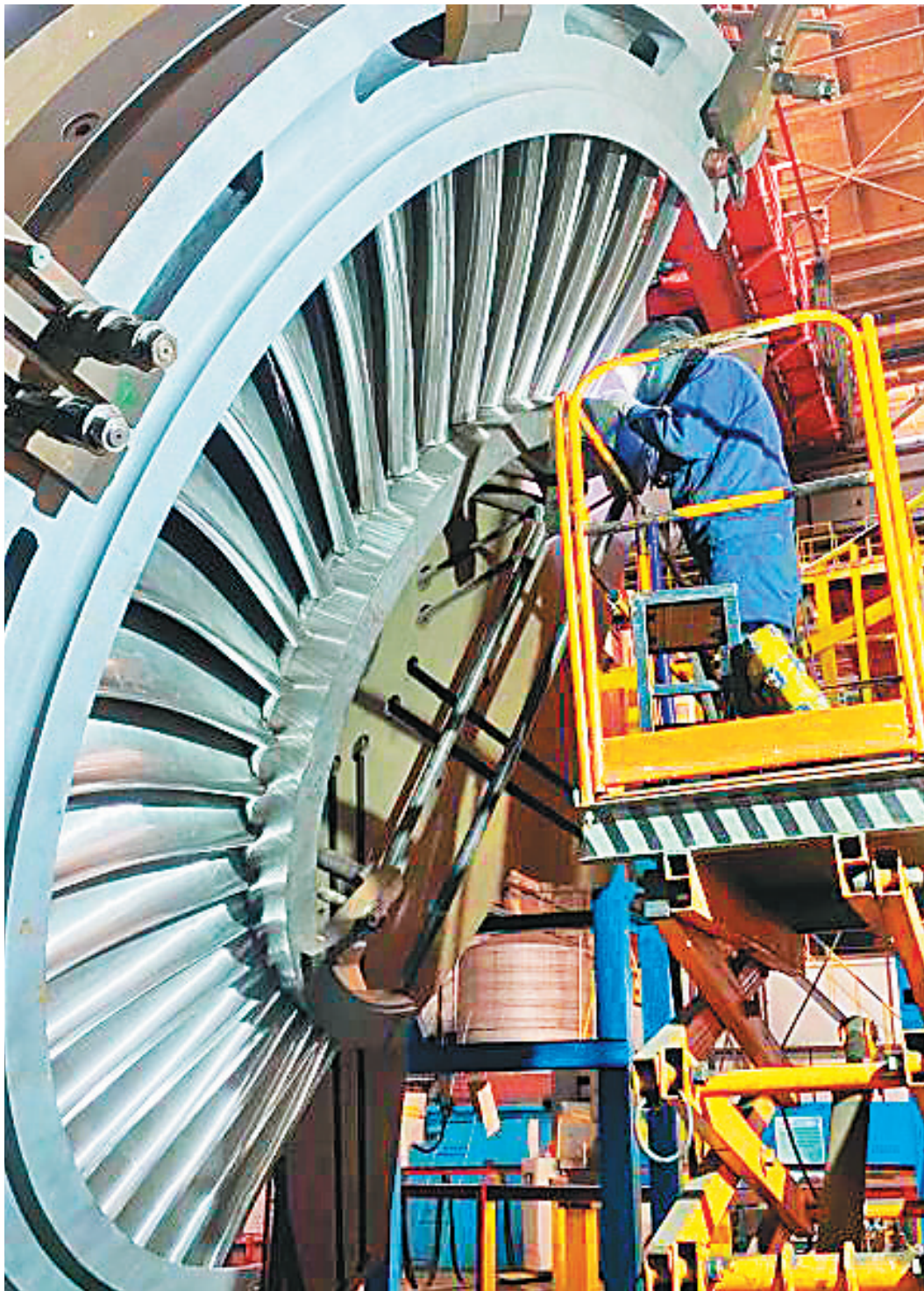
哈电集团汽轮机冷作分厂员工正在加紧抢制罗源湾项目末级隔板。
