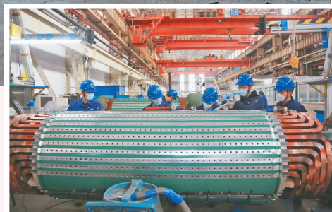
哈电集团电机公司操作者为小空冷调相机转子进行下线。
