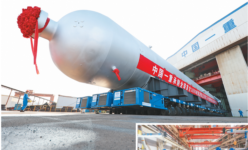
中国一重承制的全球首台3000吨浆态床加氢反应器。
