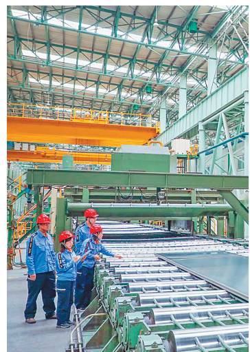
上图:东轻公司中厚板厂生产操作人员为吊运的板材进行表面质量检查。
