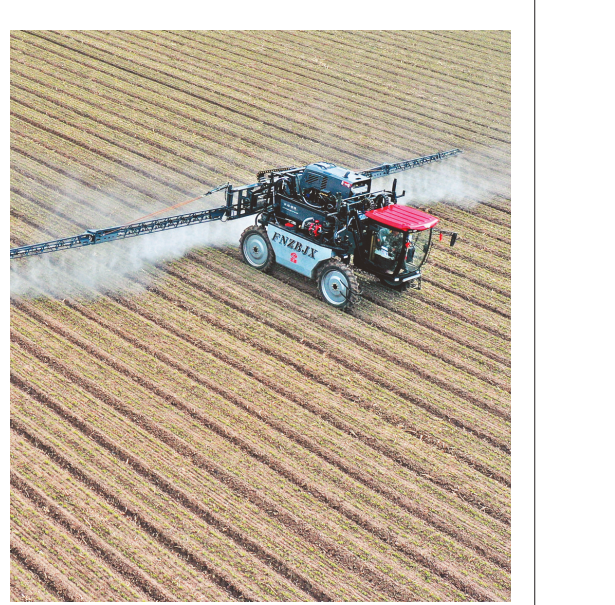
自走式多功能植保机进行高效喷药作业,减少农药的用量。谭龙摄
