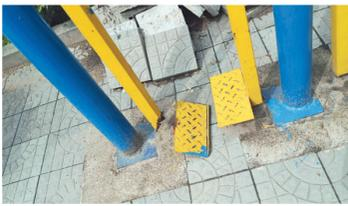
落地式双人漫步机,一个脚蹬子锈蚀断裂。
