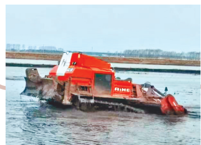
无人驾驶履带式拖拉机进行水整地作业。
