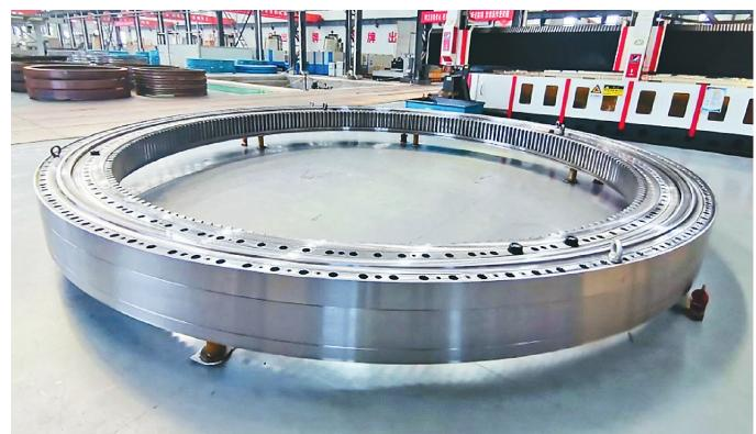
单重最大的盾构机用主轴承,将 安装在直径16米级的超大型盾构 机上,用于隧道工程挖掘。经国家 轴承质量检验检测中心检测和专 家组评审,认为该主轴承各项技术 性能指标与进口同类主轴承相当, 满足超大型盾构机装机应用需求。
