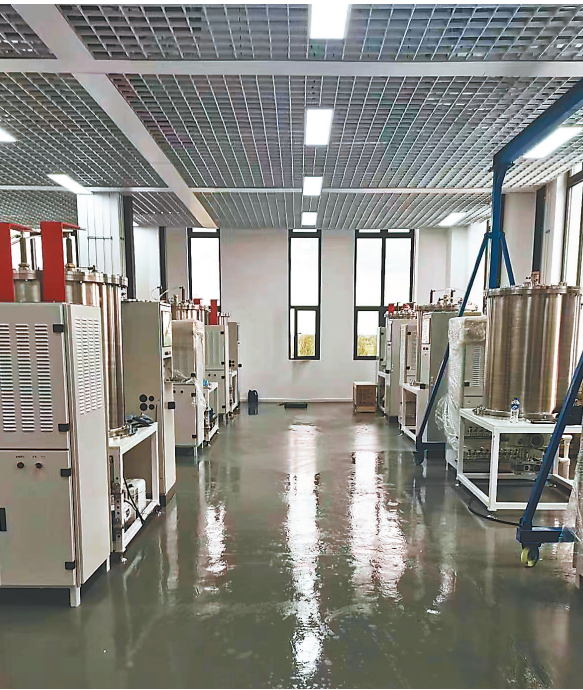
左图:8吋碳化硅晶体。 右图:碳化硅电阻长晶炉。 图片由科友半导体提供
