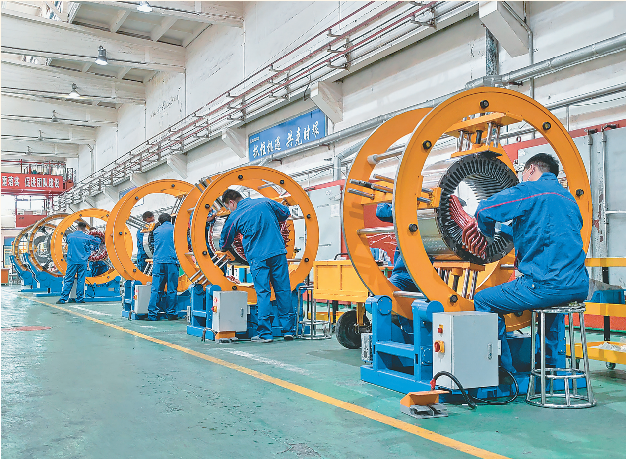
电工车间下线班组正在进行下线工作。
