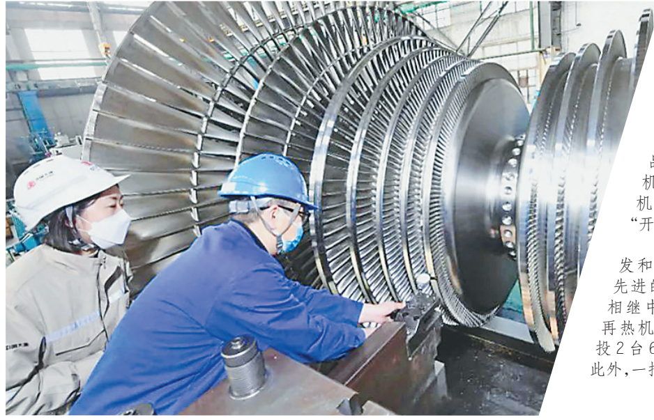
操作者对加工完的转子进行自检。
