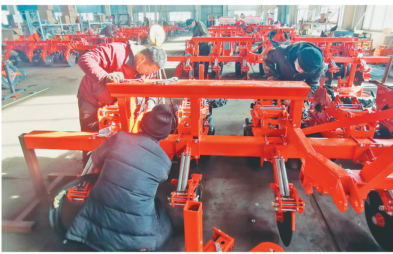
工人们正在进行七行免耕播种机整机装配工作。孟爽 本报记者 赵宇清摄
