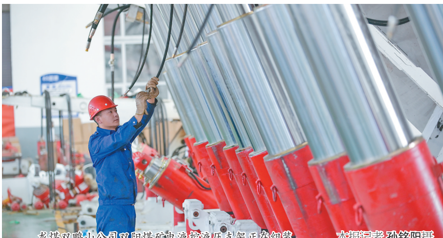
龙煤双鸭山公司双阳煤矿液控液架正在组装。
