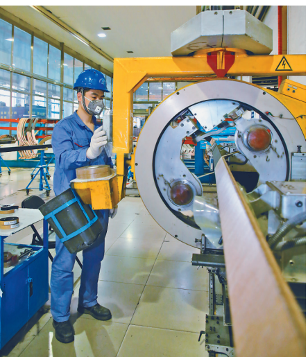
镇海燃气轮机定子线圈主绝缘包扎。
