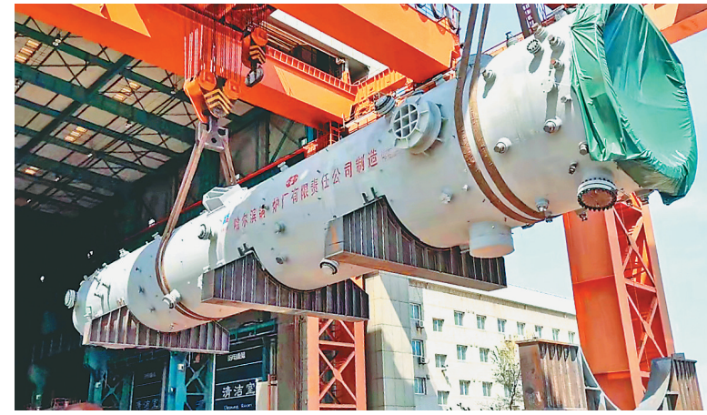
盛虹炼化项目辐射废锅。 图片由哈电锅炉提供
