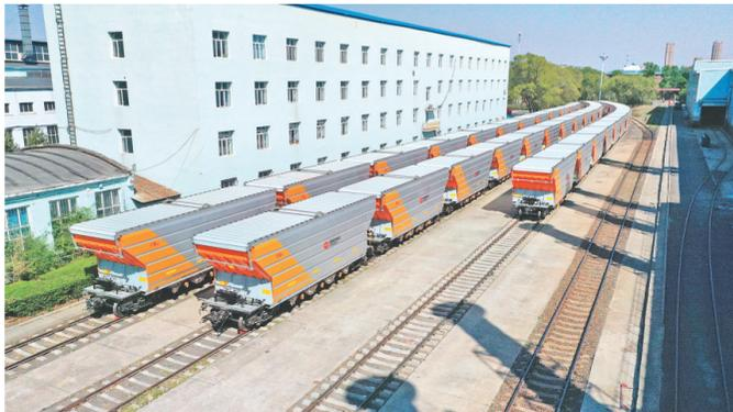
近日,由中车齐车集团齐车公司自主研制的100辆25吨轴重KM81型铝合金煤炭漏斗车正式下线并交付用户,这是我国首创的轻量化、智能化自卸式煤炭漏斗车。张云松摄
