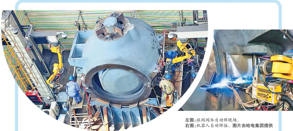
左图:球阀阀体自动焊现场。右图:机器人自动焊接。图片由哈电集团提供
