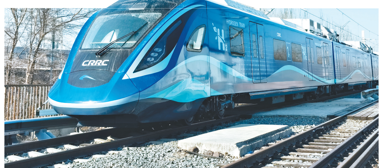
我国自主研发首列氢能源市域列车在位于长春的中车长客试验线进行运行试验。
