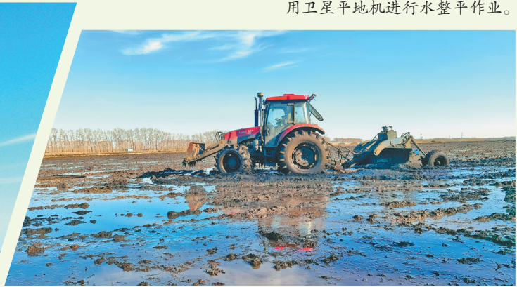
用卫星平地机进行水整平作业。
