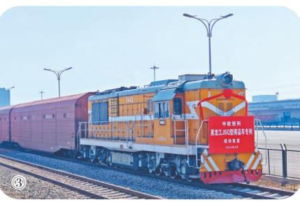
贯通,汽车可直接驶入车厢,大大提高装车效率。
